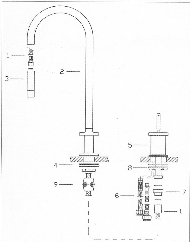
Per l'installazione del monocomando lavello ZP1266 prevedere due fori sul piano del diametro di 35 mm per la bocca e di 50 mm per il corpo del monocomando, dopodiché procedere come segue:
